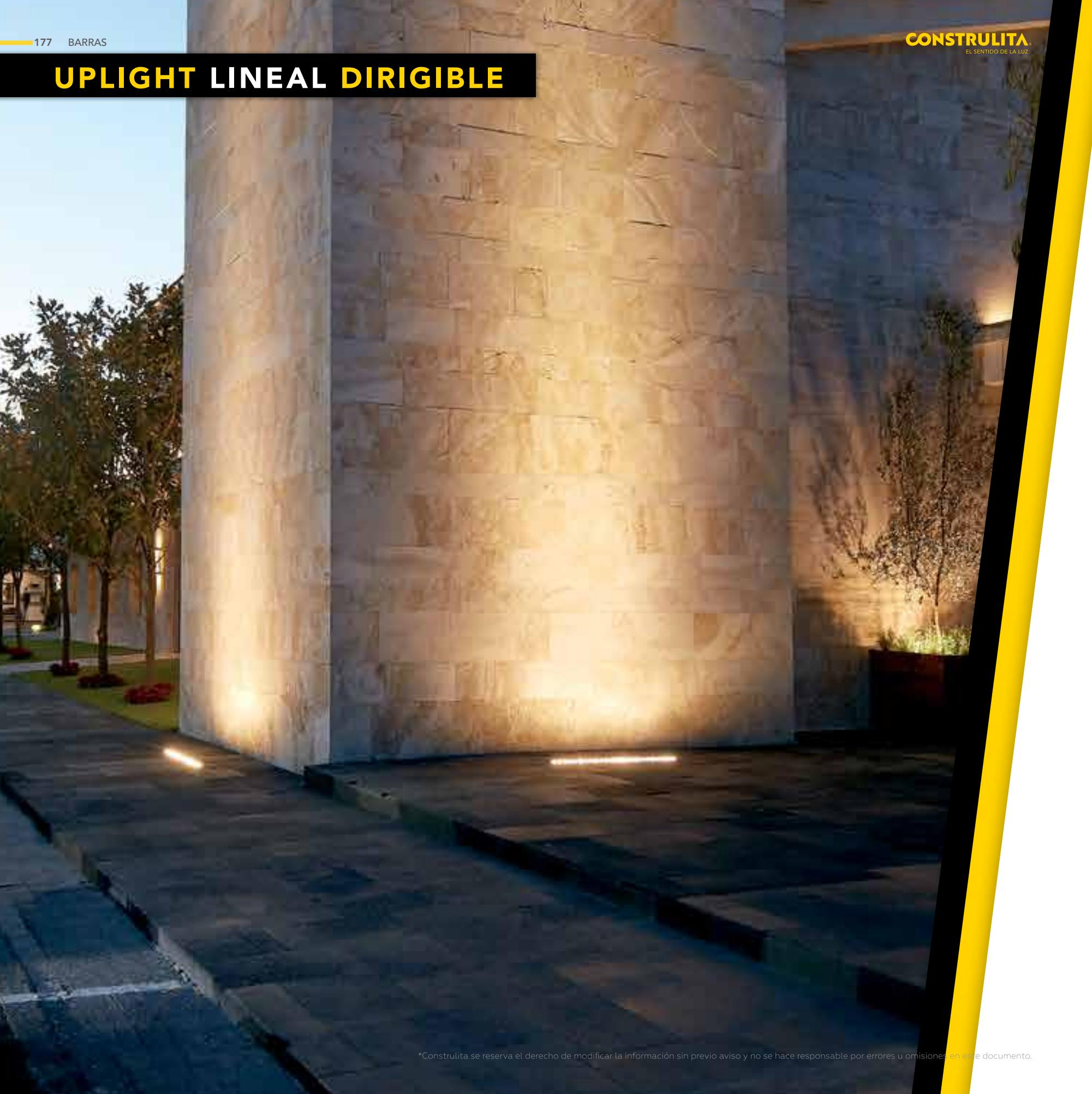
Luminarios lineales de 50cm de longitud, diseñado para empotrarse en piso; cuenta con un cuerpo óptico dirigible para facilitar enfocar algún objeto o regular el efecto deseado al tener iluminación rasante en superficies verticales.
