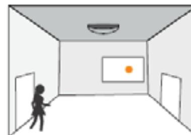
Con la suficiente luz del día, incluso cuando se detecta movimiento, la luz permanece apagada.
