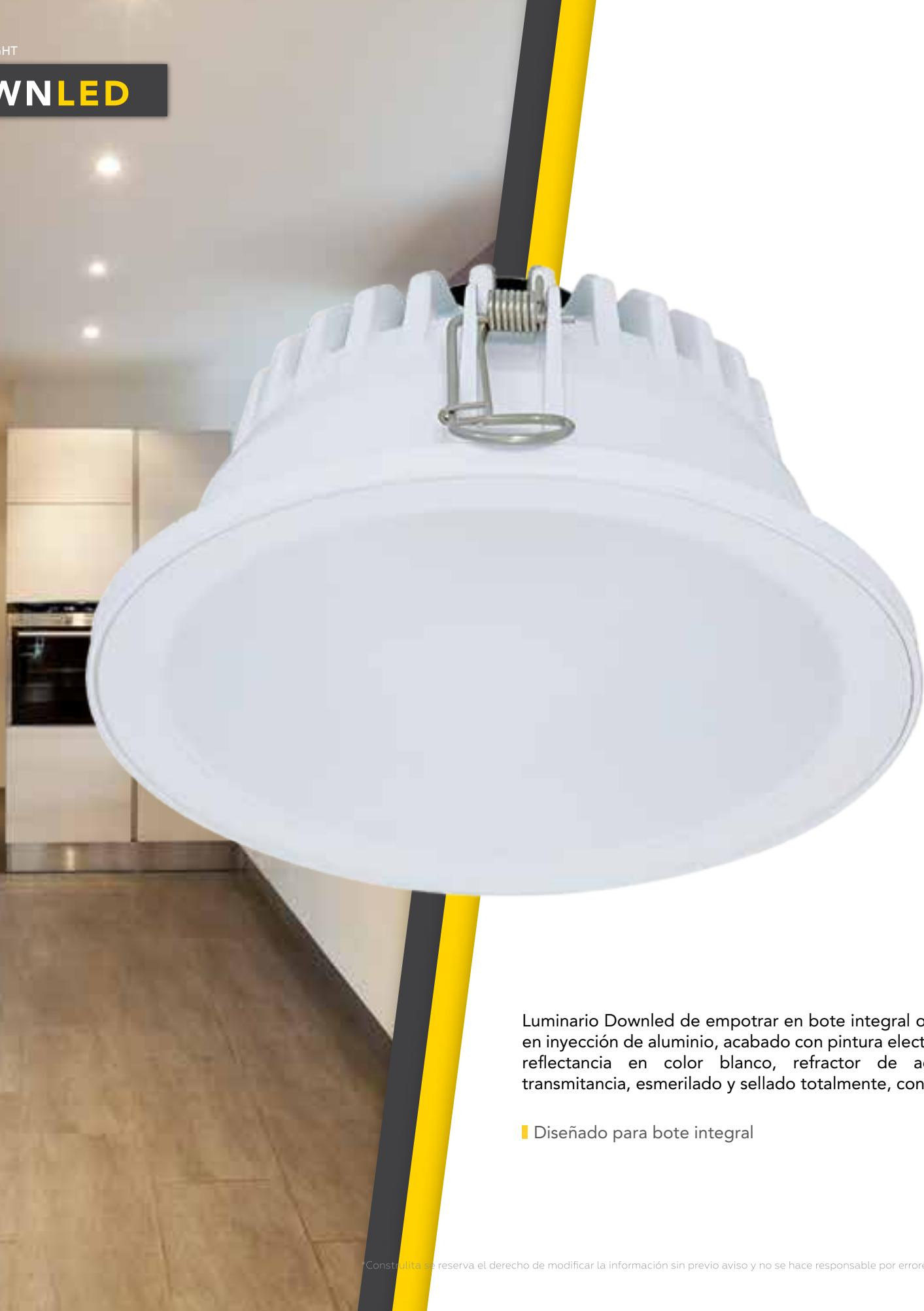
Luminario Downled de empotrar en bote integral o plafón. Cuerpo en inyección de aluminio, acabado con pintura electrostática de alta reflectancia en color blanco, refractor de acrílico de alta transmitancia, esmerilado y sellado totalmente, con tecnología LED.
